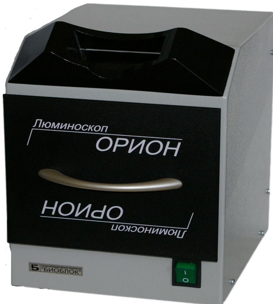
Люминесцентный анализ позволяет определить начальную степень порчи продуктов питания. С его помощью нетрудно сделать заключение о качестве продуктов и, следовательно, предупредить возникновение пищевых отравлений. Люминескоп "Орион" позволяет проводить исследования: растительных масел, мяса, рыбы, творога, сыра, картофеля и овощей, грибов, муки и зерна.
