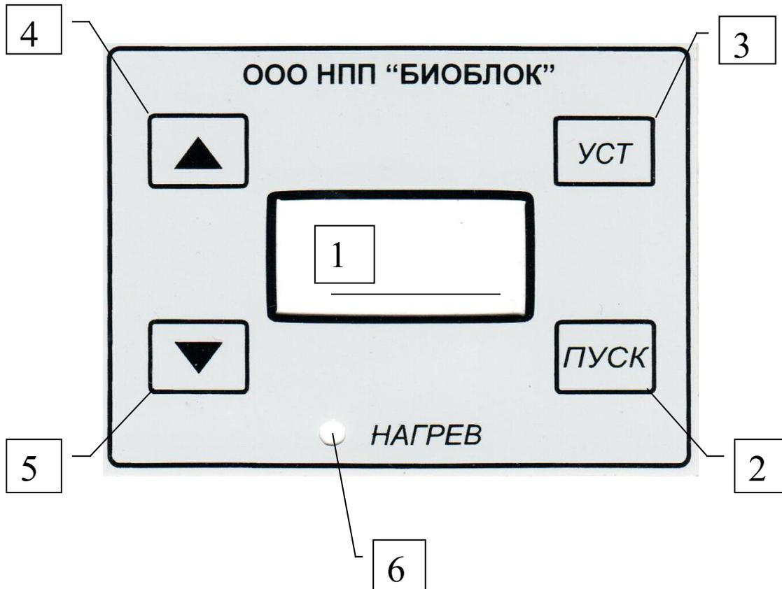
**"БВ-24"** конструктивно представляет собой водяную баню с электроподогревателем, снабженным электронным термостабилизатором. Лабораторная баня поддерживает температуру при условии, что температура окружающей среды не превышает рабочую температуру.
